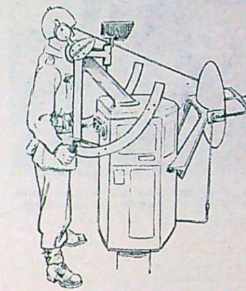
Riktstativ med radarsikte är en lättare men också mindre noggrann apparat än det stora och otympliga centralinstrumentet.
