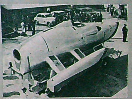
Med pontoner för balans och en de Havilland »Ghost» reamotor för fart har John Cobb utrustat sin nya världsrekordbåt.
