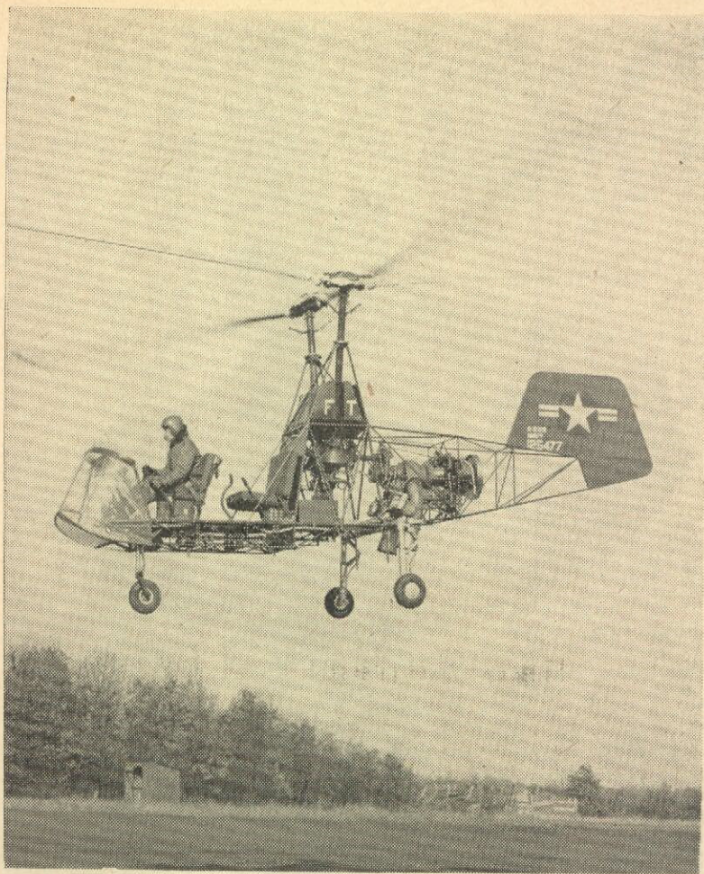
Kamans senaste, en Kaman K-225 tvårotorig helikopter med en Boeings gasturbin på sin första provflygning, som ägde rum i december 1951. Första gasturbindrivna helikoptern i världen! Nedan en Kaman HTK-1, övnings- och träningshelikopter apterad såsom ambulans.
