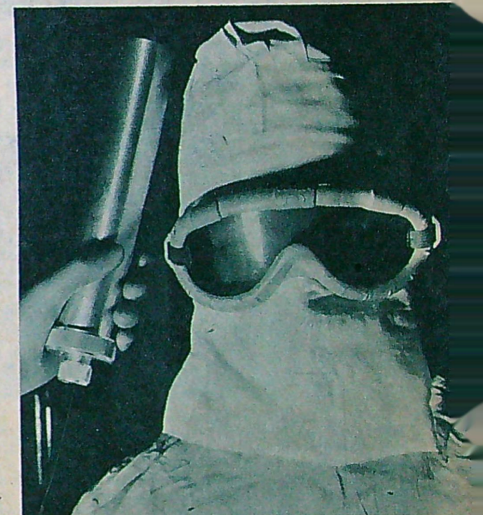
Sedan en läkare använt radioaktiva preparat kontrolleras hans kläder noga med den outhärliga Geigermätaren.
