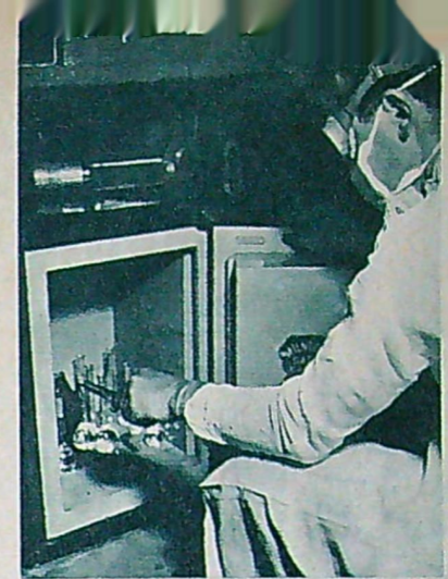
6 När de radioaktiva preparaten inte används förvaras de i skåp med tjocka blyväggar för att deras farliga strålning inte skall kunna göra någon skada.
