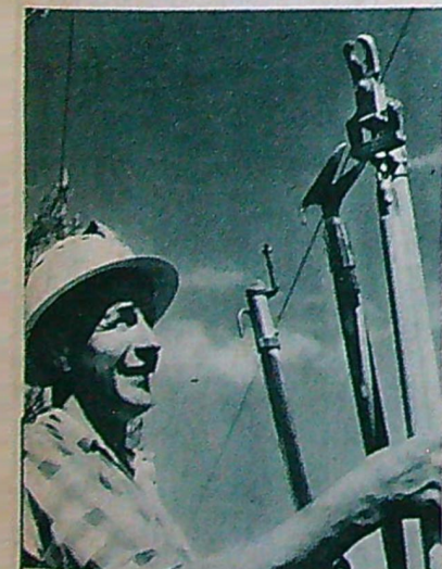
Förman David Eriksson kontrollerar att verktygen är oskadade. I mitten en alligator. T. h. en lång som manövreras m. stavar.
