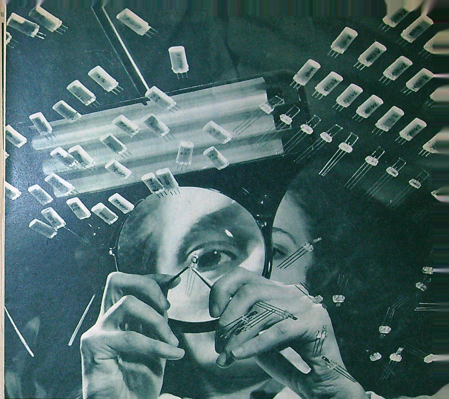
Det kräves ett mycket säkert öga och en stadig hand för att placera de tunna trådarna (som kattmorrhår) mot germaniumskiktet. Det hela innesluts sedan i ett plasthölje som skyddar den lilla transistoren mot stötar, vibrationer och fuktighet bland annat.
