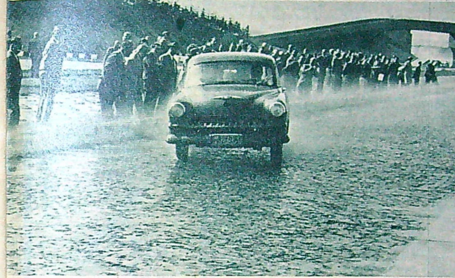
På Opels provbana kan vagnarnas vägegenskaper testas under alla tänkbara vägbeläggningar. Här har Kapitänen kommit i sladdning på en hal stenbeläggning, men föraren behärskar situationen elegant. Under detta prov begjuts vägen med vatten från en hel rad »duschar» t. v.
