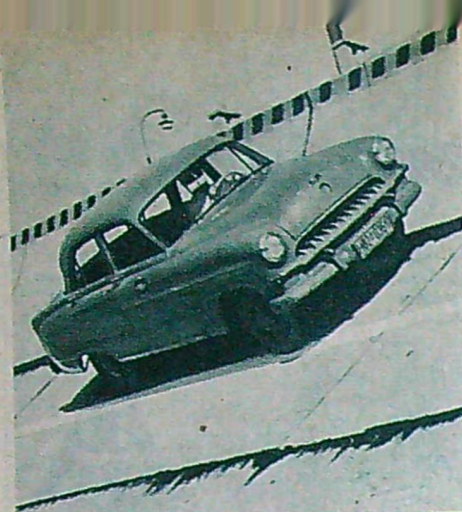
Med 120 km/t rusar nya Opeln runt den 1,5 km långa doserade hastighetsbanan. Där körs tusentals km under proven.
