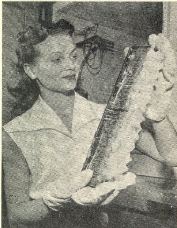
★ KYLSLAGEN ELHJÄRNA. Elektronutrustningen i ett flygplan skall tåla både värme och köld. Här har en "elhjärna" provats i kylrum hos North American och klarat det arktiska gradtalet med glans.
