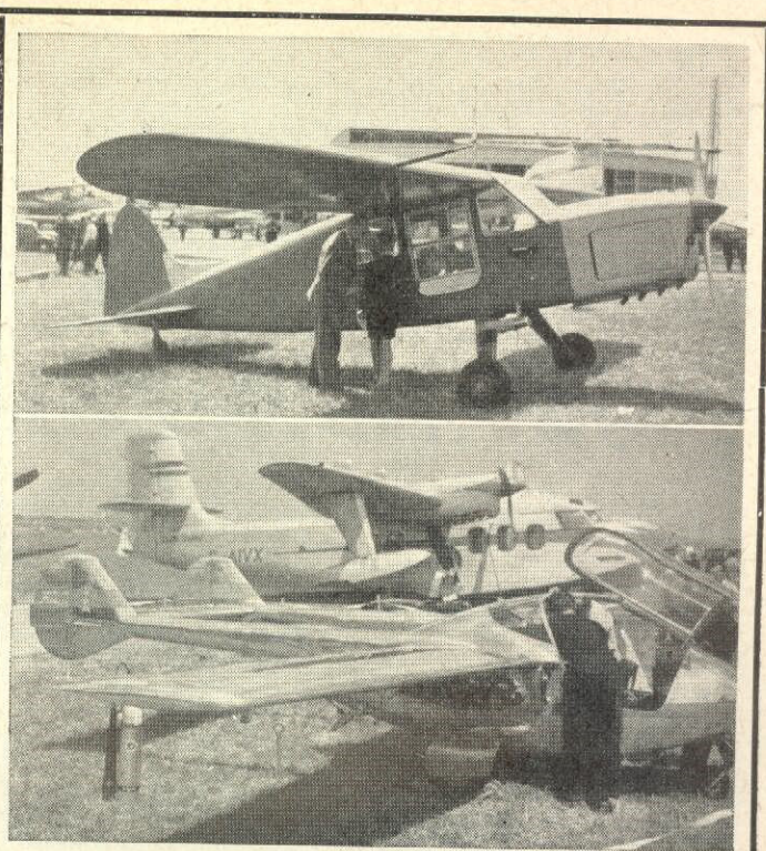
Överst fyrsitsigt reseflygplan P. A. 204 som gör 245 km/tim. Under det första reasportplanet i världen (?) SIPA 200 Minojet, tvåsitsigt med infällbart nosställ och en Turbomeca Palas på 150 kp dragkraft. Spännvidd 7,20 m, längd 5,12 m, tomvikt 363 kg, max flygvikt 707 kg, maxfart 430 km/tim, marschfart på 1.000 m. 380 km/tim, max flygsträcka 700 km. Startsträcka 350 m
