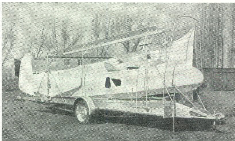
EN BRA TRANSPORTVAGN som passar till Weihe och Kranich 3 (och förmodligen även till vår Kranich) tillverkas av Focke-Wulf i Bremen. Den kostar 2.950 DM utan och 3.450 DM med kupell
