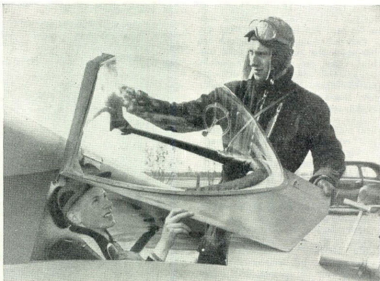
BÄTTRE HUVAR till våra segelflygplan har länge varit ett önskemål. De börjar komma nu. Här ser vi en av Allebergs Baby-Falkar med den nya "Birger-Nilsson-huven", som bara har det felet att ventilationen är dålig. Ett fel som är lätt att korrigera. Huven finns även till bl. a. Olympia
