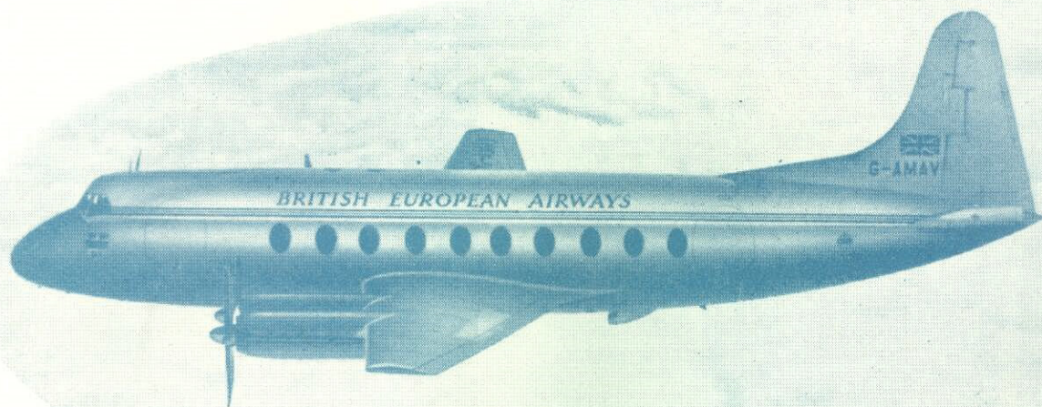
Vickers Viscount. Fyra Rolls-Royce "Dart" motorer.
