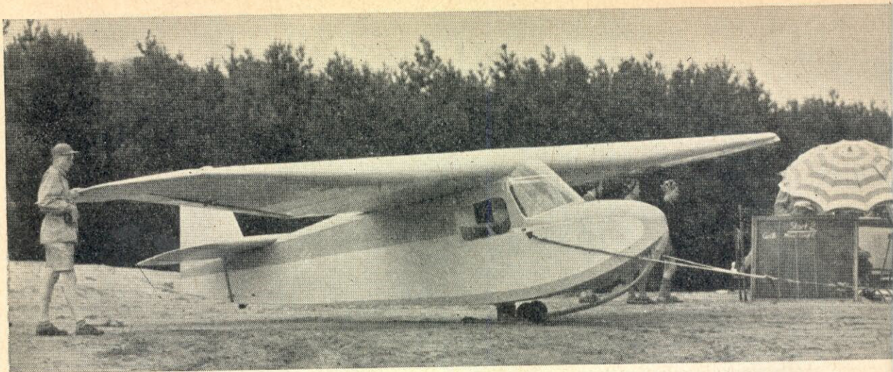
Möve är namnet på den rultiga skapelse av Heini Dittmar, ett segelflygplan av trä och duk som med ytterst enkla modifieringar kan göras om till antingen motorseglare eller rent motorflygplan. Vi återkommer i ett senare nummer till typen. Lagg märke till "skulderkopplingen" som nästan genomgående användes i Tyskland
