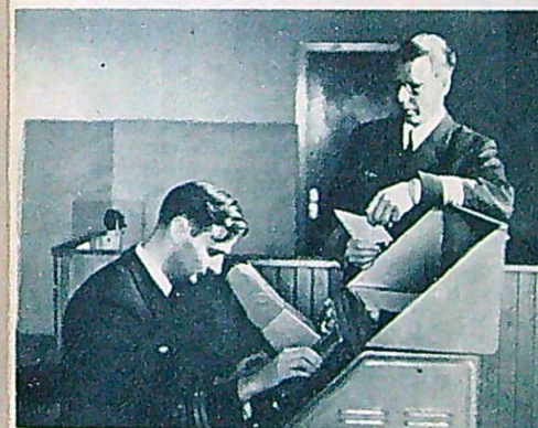
Meteorolog Lennart Westerdahl och stabsmeteorolog Tage Ericsson kontrollerar med denna apparat molnens storlek och höjd. Molnhöjdsjäkmätaren har räckvidd upp till 15.000 m.
