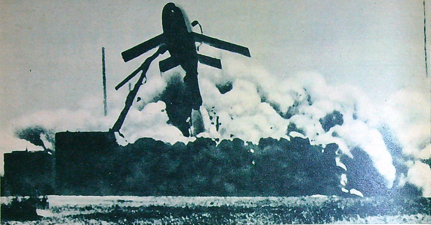
En Ryan Firebee startar i ett moln av rök och flammor. Denna fjärrstyrda amerikanska robotprojektil kan användas som mål för luftvärnet.
