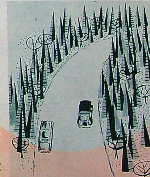
Om en väg skall stakas genom ett skogsparti, kan man genom att lägga den i mjuk kurva undvika att landskapsbilden blir förfulad.
