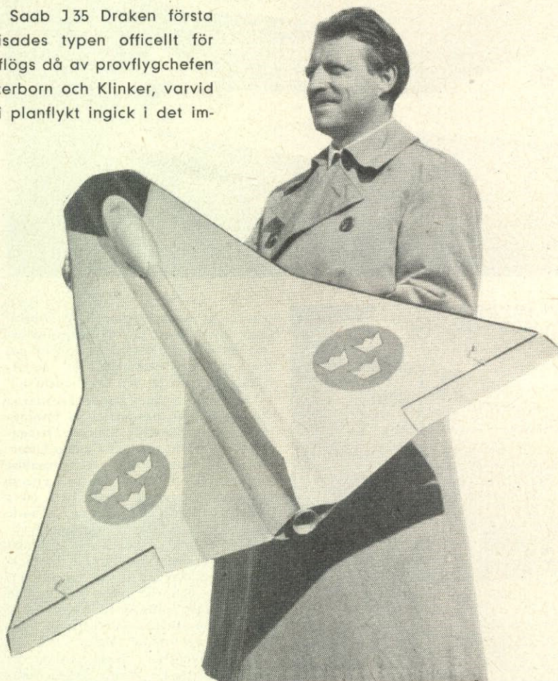
Flygprovchefen Bengt Olow med en av de svingline-modeller med vilka de första rönen om Drakens landningsegenskaper gjordes
