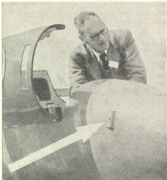
Segelflygexvärldsmästaren Philip Wills har använt totalenergivariometer på sin "Sky" enligt Kendalls system
