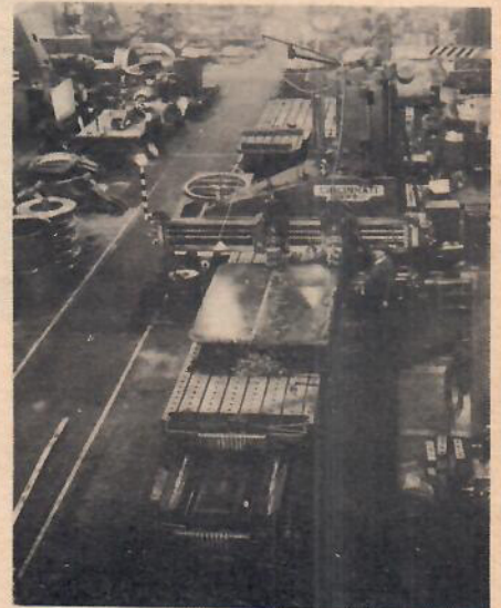
Bordhyveln hör till de större enheterna maskinverkstaden. Stora järnplåtar och balka hyvlas ned lika lätt som en bräda i snickeriet.
