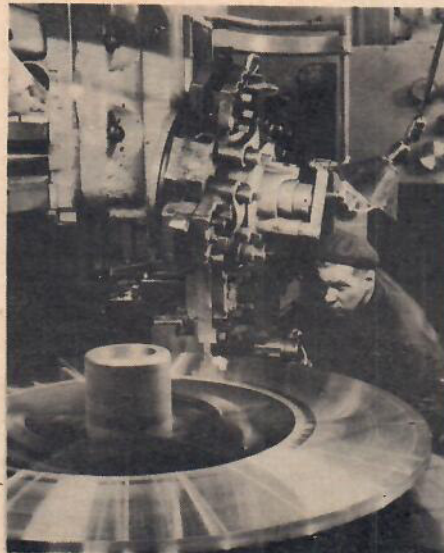
I den stora maskinparken intar karusellsvarven en framskjuten position. Karl Pettersson svarar här bottnar till sockerfabrikscentrifuger.
