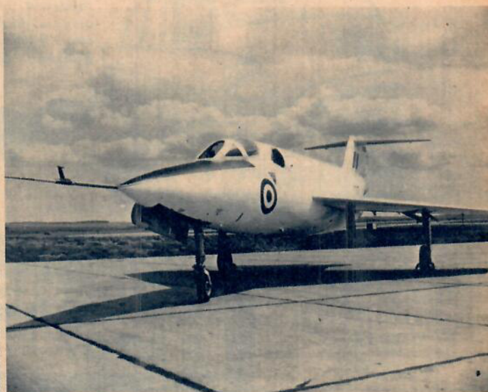
Saunders-Roe S.R. 53 är det första brittiska flygplanet med raketmotor som huvuddrivkraft. Raketmotorn är kompletterad med vanlig reardrift.
