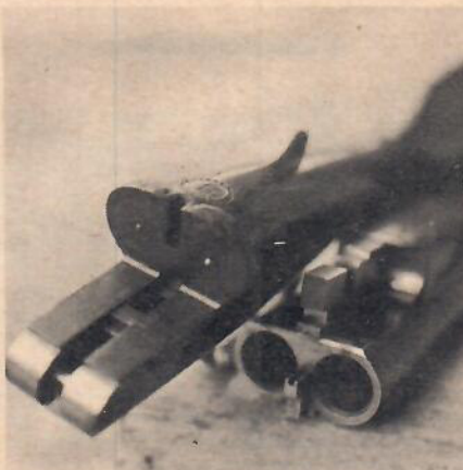
Det vanliga gevärets tändstift är utbytt mot elektriska kontakter isolerade från utlösaren.
