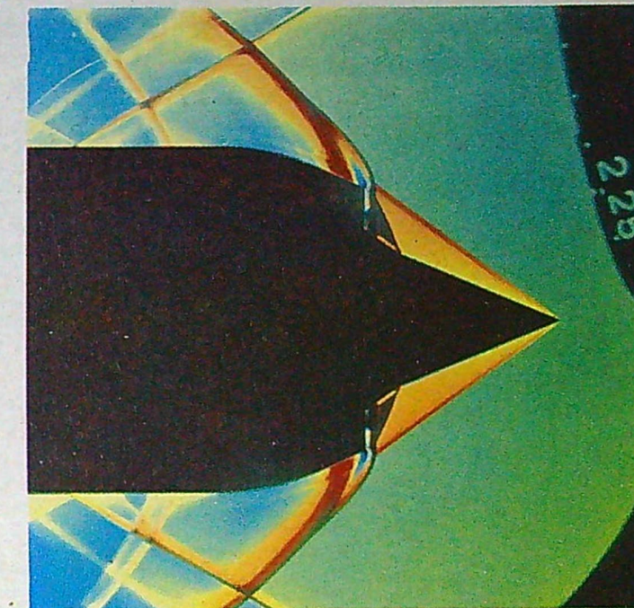
Slirbild av en modell i en av Flygmotors vindtunnlar tagen vid Machtalet 2,25. De olikfärgade linjerna avslöjar strömningsförlöppen runt modellen.
