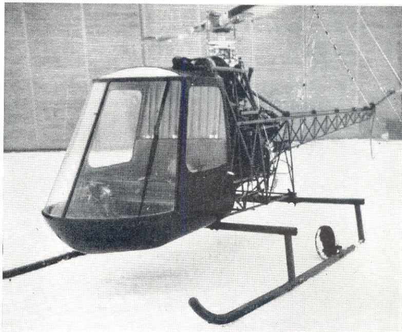
Kjøseths helikopter är 7 m lång, 1,20 m bred och har en rotordiameter av 9 m. Motorn är på 180 hk
