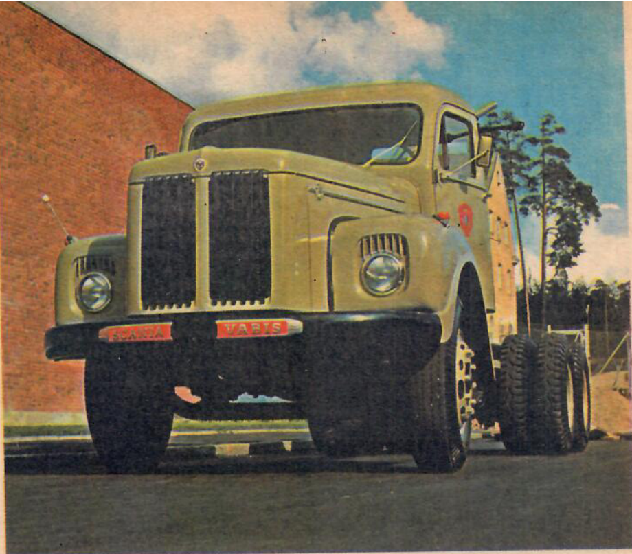
Medge att det är något visst med lastbilar. Den här nosan inger respekt och varslar om ordentliga krafter. Den nya Scania är på 165 hästar. Motorn är en helt nykonstruerad sexcylindrig diesel.
