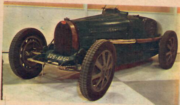
Bugatti, det säger väl allt. Årgång 1929. Motorn var på 1995 kubik. Hästkrafterna 135 och toppfarten omkring 200 km/t. En skönhet som gott kan ta upp kampen om elegansen med nya bilar.
