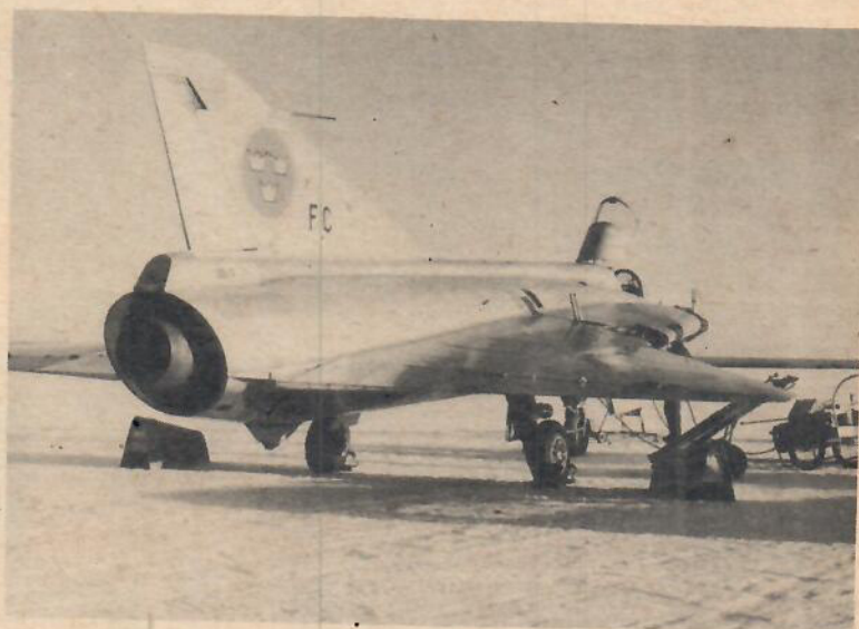
Draken — här på Kallax flygfält under köldproven — ser en smula tung ut i gumpen i det är perspektivet. Att den inte är det framgår av de helt nyligen frisläppta uppgifterna om bl. a. stighastigheten — 200 meter per sekund!
