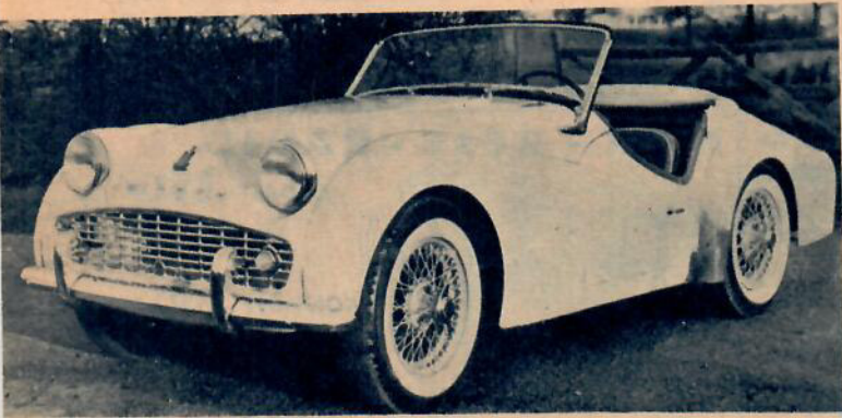
1958 års Triumph bjuder på en del nyheter. Grillen är ändrad och kylarmärket har blivit kompletterat med ordet Triumph. Strålkastarna är insänkta och körriktningljusen fristående. Fortfarande 100 hästar i motorn.
