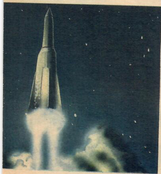
En satellituppsändning går i princip till på följande sätt: En trestegsraket (på bilden i storlek och utseende lik den amerikanska interkontinentala roboten Atlas) har startat från sin bas.
