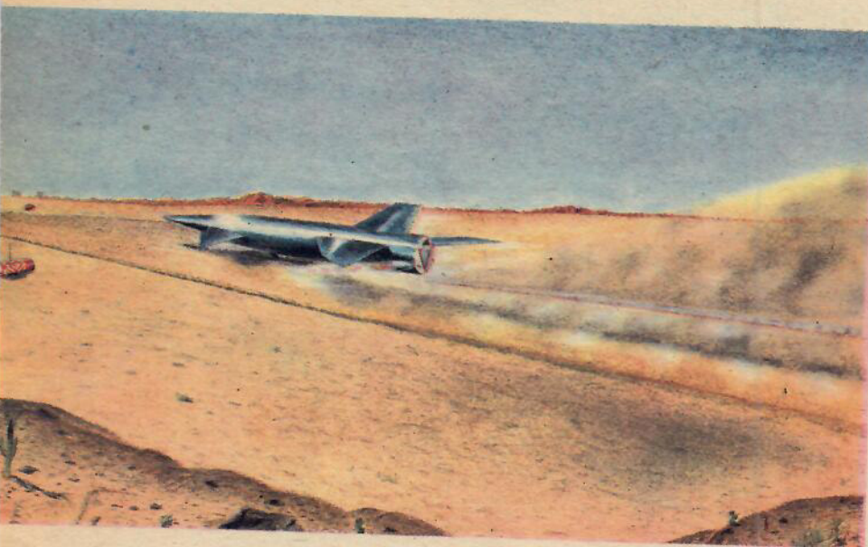
På rymdstationen har raketerna byggts om till ett hypersoniskt glidplan. Efter att ha bromsats in under flera varv i en ellipsbana kring jorden kommer det in i tätare luftlager där aerodynamisk styrning medges. Som ett flygplan landar månfarkosten i den öken varifrån starten skedde.
