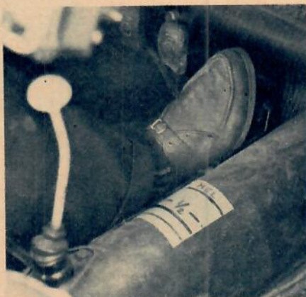
Volkswagen hade en unik skvallermätare. Här visar den på kvartsgas. Nedan ses klassegrärens vagn under provtagning före loppet. Observera enliterstanken vid bakrutan på bilden.
