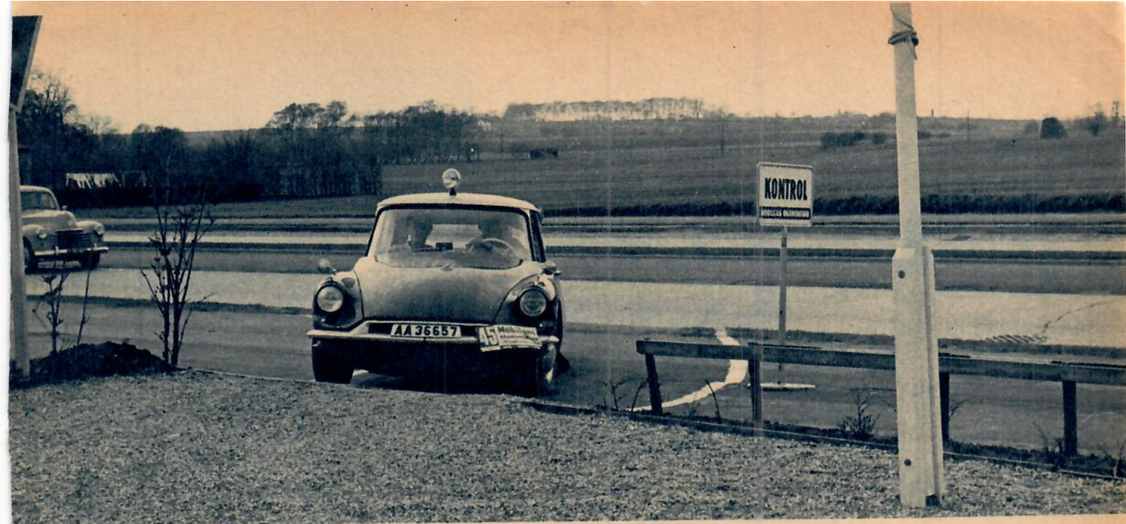
Teknikens Världs Citroenekipage rullar in till en kontroll. Vagnen drog under 1.592 km 0,702 l/mil. Upplysningsvis vill vi tala om att den ej bantats.
