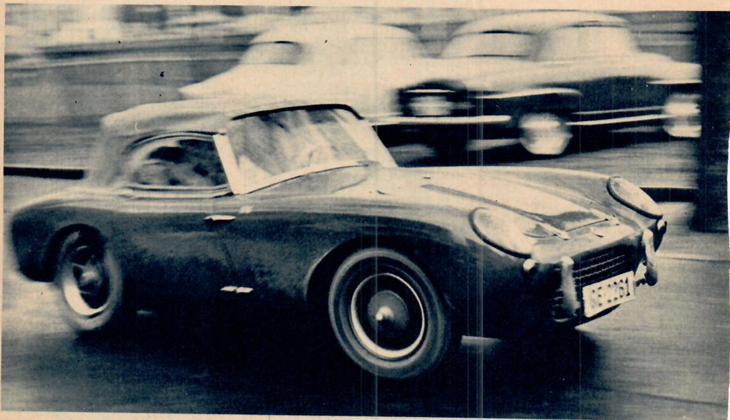
Den lilla Berkeleyn har vuxit till sig ordentligt och har numera en trecylindrig tvåtaktare med tre förgasare under huven. Under en kort prov-
