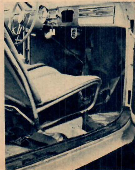
Föraren på en Isabella hade störhjälm under fotsulan för att inte trampa för djupt på gasen. Dörklädsel av tunt bomullstyg. Nedan insidan på en deltagande »standardvolvo».
