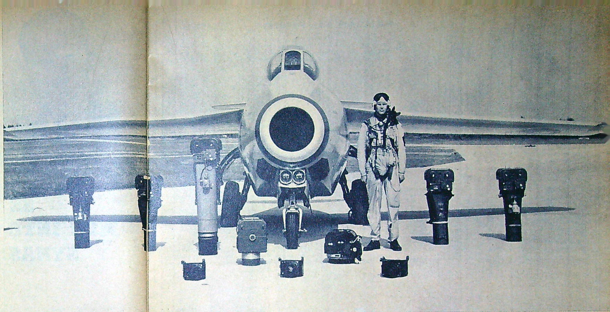
ar utom bakåt. Den sammanlagda filmlängden till sex kameror är ca en halv kilometer. Bilden visar kameror för olika utrustningsalternativ. Längst fram ses tre snabbseriekameror för låghöjdsfotografiering, bakom dem två kameror för kartläggning från 1.000 till 10.000 m höjd. Med kamerorna ytterst till höger och till vänster tar man bilder från över en mils höjd. Den största kameran har en brännvidd på 1,5 m och används på distanser över två mil.
