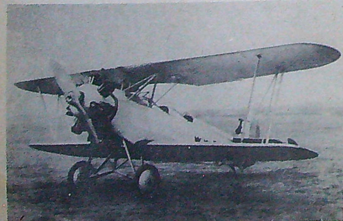
Raab-Katzenstein »Tigerschwalbe» var från början ett ensitsigt »konstflygnings»-flygplan. Ett antal inköptes av Flygvapnet, försågs med ytterligare en sittbrunn och gjordes till skolflygplan med beteckningen Sk 10.
