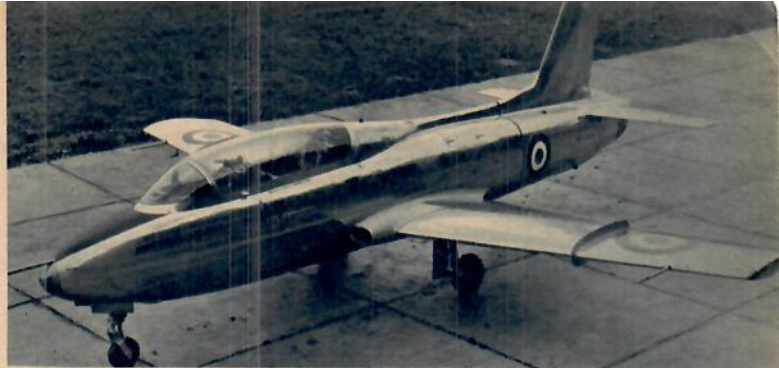
Den italienska Macchi MB 326 ligger nära idealet när det gäller skolflygplan. Detta gäller både utformning och prestanda. Planet har konstruerats med avsikten att utgöra enda skolflygplantyp under den grundläggande flygutbildningen. Sitsarna är placerade i tandem och läraren sitter bakom och högre än eleven. Sikten är mycket god, huven saknar skyddande lister.
