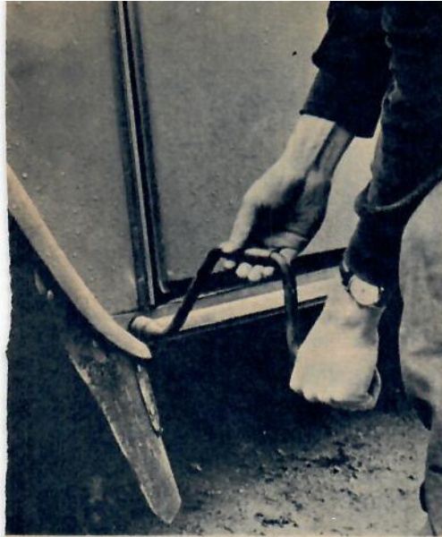
Universalverktyg nummer ett. Vevslängen passar både till hjulbultar och flyglarnas fastsättning. Fyra bultar håller varje framflygel!!!!
