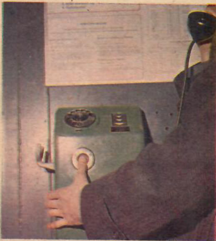
Här är den nya typen av telefonautomat som är försedd med en särskild SOS-knapp. Härifrån kan man kostnadsfritt ringa SOS-centralen.
