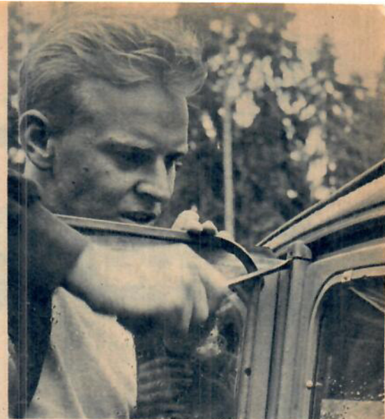
Den genialiska dörrfastsättningen i närbild. Man lossar en skruv, ger låshylsan en puff med mejseln och det är klart att lyfta av dörrarna.
