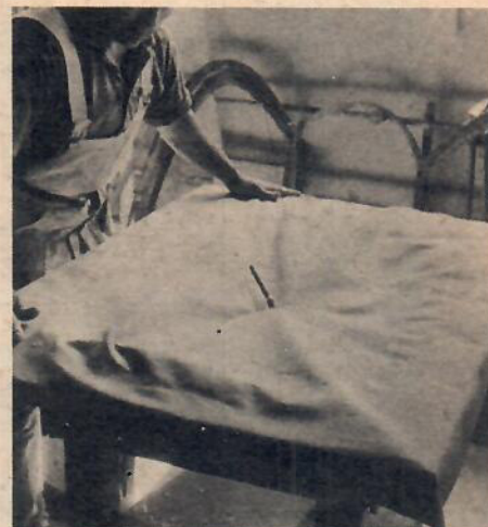
En gummiduk placeras över och luften sugts ut. Det yttre lufttrycket får verka som innerform.
