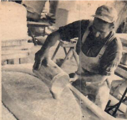
Den flytande plasten hälls direkt ur en burk på den tillklippta glasfibermattan och så...
