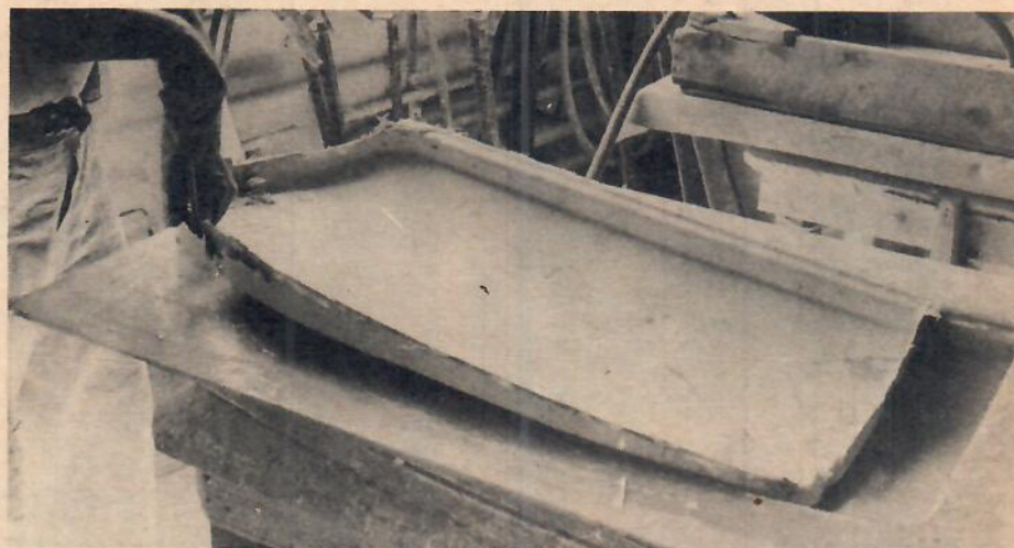
Bilden ovan: Här bänds den färdiga dörren loss från formen. Hela härdningsproceduren har tagit en dryg kvart. I bakgrunden håller en annan dörr på att härdas i sin form. Bilden nedan: Karossen är klar. Innan den levereras spolas den ren. Det är dammet från slipningen som skall bort.
