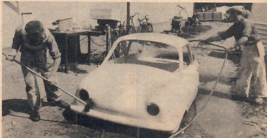
Bilden ovan: Här bänds den färdiga dörren loss från formen. Hela härdningsproceduren har tagit en dryg kvart. I bakgrunden håller en annan dörr på att härdas i sin form. Bilden nedan: Karossen är klar. Innan den levereras spolas den ren. Det är dammet från slipningen som skall bort.
