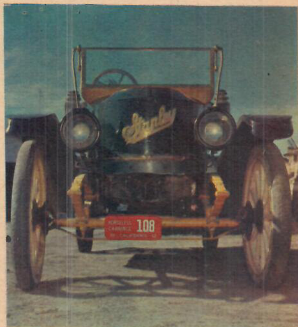
1915 såg den här ångbilen, en Stanley, dagens ljus. Bakom den bulliga nosen sitter ångpannan. Stanley gjorde sensation 1906 genom rekordfarten 195,657 km/t på den flygande kilometern. Full fyr i pannan!
