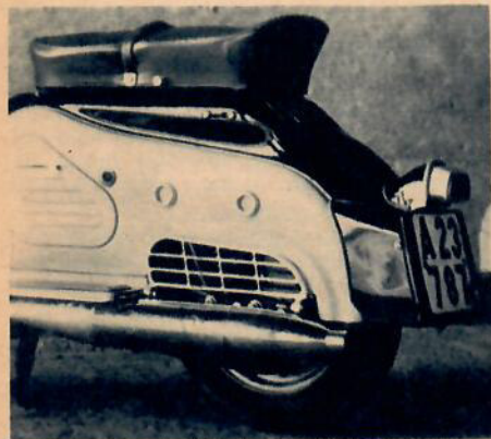
Genom luckorna på skotersidorna nås lätt förgasare och andra detaljer för nödvändig service.
