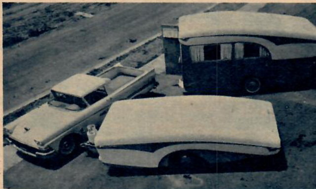
Husvagnen på bilden ovan är tillverkad av en firma i Californien. Glasfiberkarossen är hopfällbar så att vagnen under bogseringen endast är hälften så hög som annars. Vikt 125 kg. Priset är 2 500 dollar.
