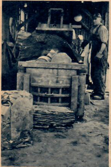
Den kraftiga pressen med 400 kg tryck per cm 2 förvandlar bildelar och annat till prydliga skrotkakor.
