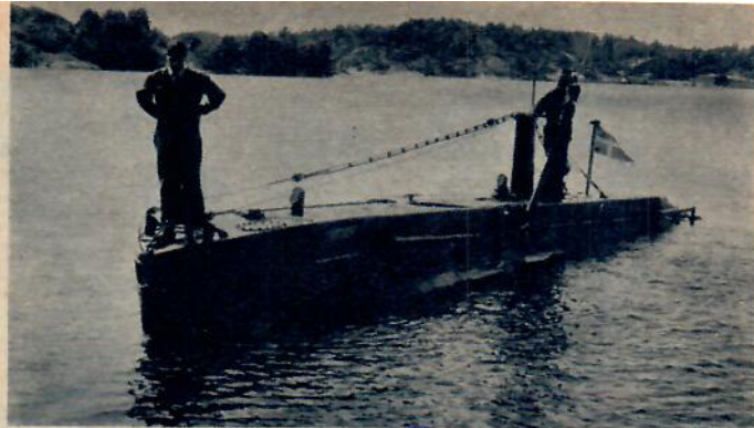
Spiggen är ett av våra minsta stridsfartyg. Den är ca 20 m lång och dess displacement är 36 ton. Den har fem mens grodmansutbildad besättning.
