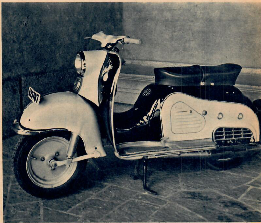
Genom luckorna på skotersidorna nås lätt förgasare och andra detaljer för nödvändig service.
