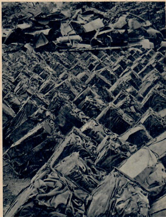
32 förgår all världens härlighet. De här hopbacklade plåtpaketet har en gång varit bilar av senaste modell och högt värde. Ca 80 kr styck är skrotvärdet på paketen som småningom smölts ned vid järnverken.
