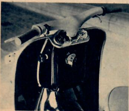
Instrumentbrädan på Bella rymmer hastighetsmätare och startkontakt. Batterierna är placerade under panelen. På bilden ses även styrlåset.
