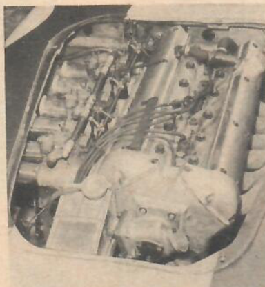
Det är trångt om saligheten under huven. (Ovan t. v.) Jaguarmotorn som syns här utvecklar omkring 260 hästar. På bilden t. h. en titt på förarplatsen. Kompakt även här.
