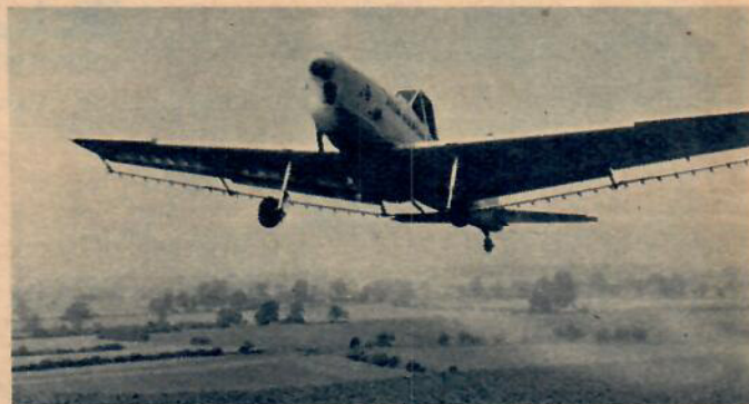
De Havilland har byggt en ny version av Chipmunk som kallas Mk 23. Den är speciellt avsedd för jordbruksflygningar. Stallhastigheten är så låg som 50 km/tim, startsträckan 180 m och flygvikten 250 kg.
