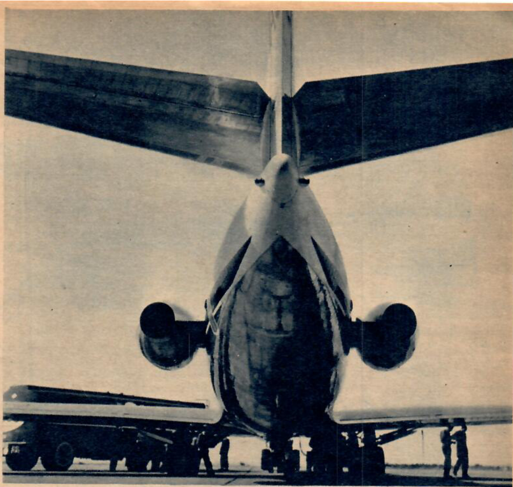
Caravelle har två Avon R. A. 29 reamotorer, vardera med en dragkraft på ca 5.000 kp. Rolls Royce utvecklar emellertid en ny motor av by-pass-typ (Conway 141) och denna bör enligt fabriken lämna sig för bl. a. Caravelle. Typ 141 har större dragkraft och ger bättre bränsleekonomi än Avon.
