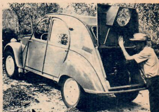
Superlillicitran 2 CV Sahara har två separata motorer. Reservhjulet ligger framtill på huven.
