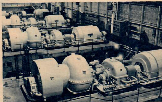
Bilderna visar kompressorläggningen som svarar för evakueringen av luften från testcellerna. Varje kompressor drivs av en elmotor på 22.000 hk.
