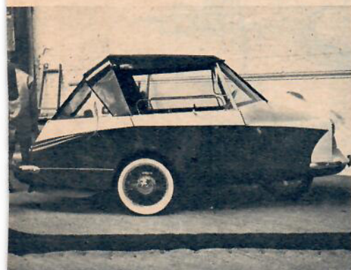
Romboidbilen Vannod var en verkligt underlig sak. Framhjulet styr och bakhjulet är ledat.
