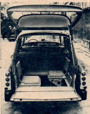
Familiale har en intressant bakdörrskonstruktion som medger maximal öppning. Obs. stolarna.
