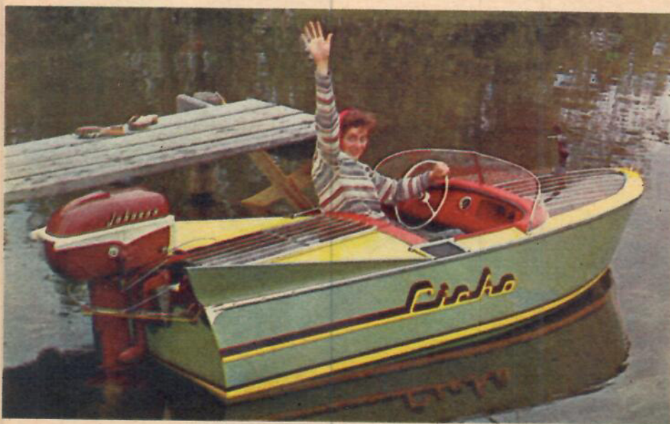
En tremetersbåt som bara väger 70 kg hör inte till vanligheterna. Så låg vikt kan man få om materialet är aluminium. Fartresurserna blir goda: 25 knop med bara 15 hästkrafter i snurren.
