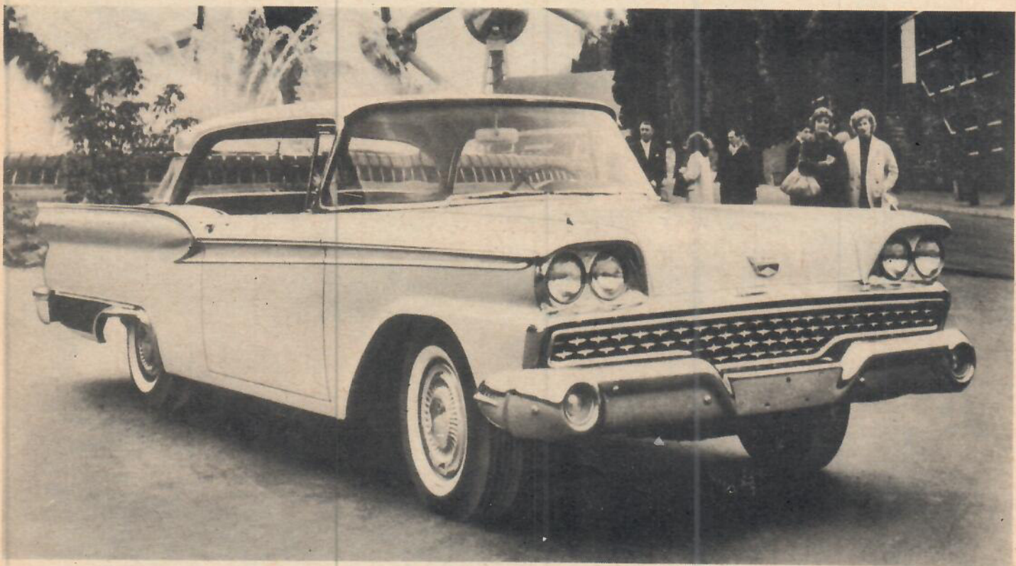
Ford är relativt lugn i sin formgivning och har kvar sitt tuffa, kantiga ansikte. Grillens stjärnor är gjutna i aluminium. Den här Fairlane har 200 hk.
