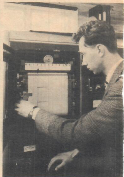
Den här apparaten registrerar solbruset och ass. Elldér kan konstatera att solen f. n. är lugn. De utslag som syns är kalibreringar av apparaten.
