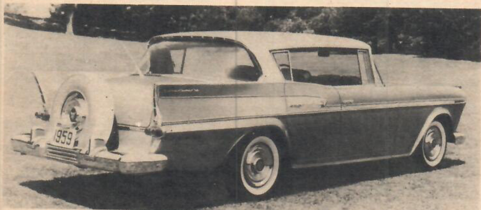
Rambler Ambassador är en av de få vanliga vagnarna med separata stolar i framsätet. Fenorna har modifierats en aning inför 1959. En praktisk detalj är att man byggt in Scotch-Lite i dess kanter.
