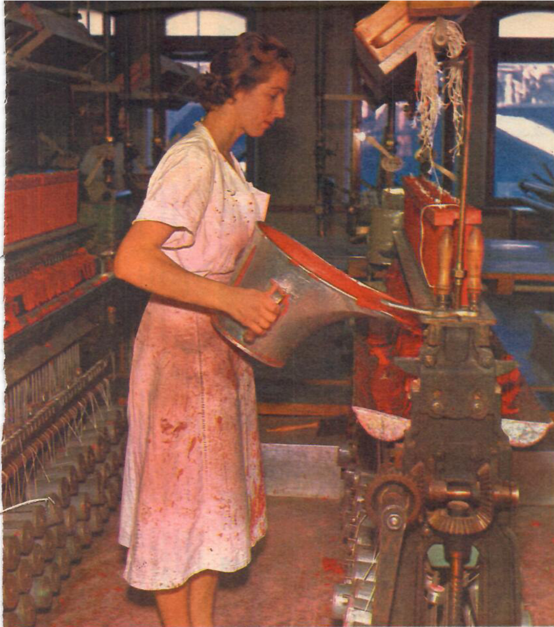
I stöpmaskinen håller fru Lucia (!) Brenna stearinmassa, vilken är färgad med askfri anilinfärg som inte bleks av stearinsyran. Från trådrullarna vid maskinens fot löper bomullsveken genom varje gjuthål. För att det inte skall bildas några luftbubblor när stearinet kallnar och stelnar värms maskinerna innan stöpningen med varmvattnet.
