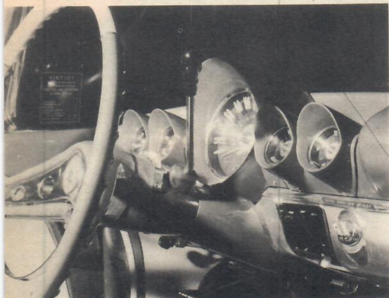
En kontrast till bilden av Cadillacs instrumentbräda. Impalan har, trots att den räknas som en sportig modell, ingen stoppning. I stället har instrumentens infattningar begåvats med vassa, utstickande plåtkanter.
