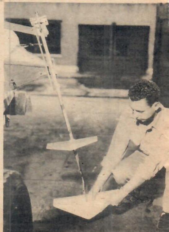
Förenta Staternas Flotta experimenterar för närvarande med bärplansbåtar. Detta är den i texten omtalade High-Pockets. Motorn är en Chrysler på 125 hästar och den ger båten en toppfart på ca 38 knop. Utan bärplan gjorde båten med samma motor endast 20 knop. En kraftig ökning.
