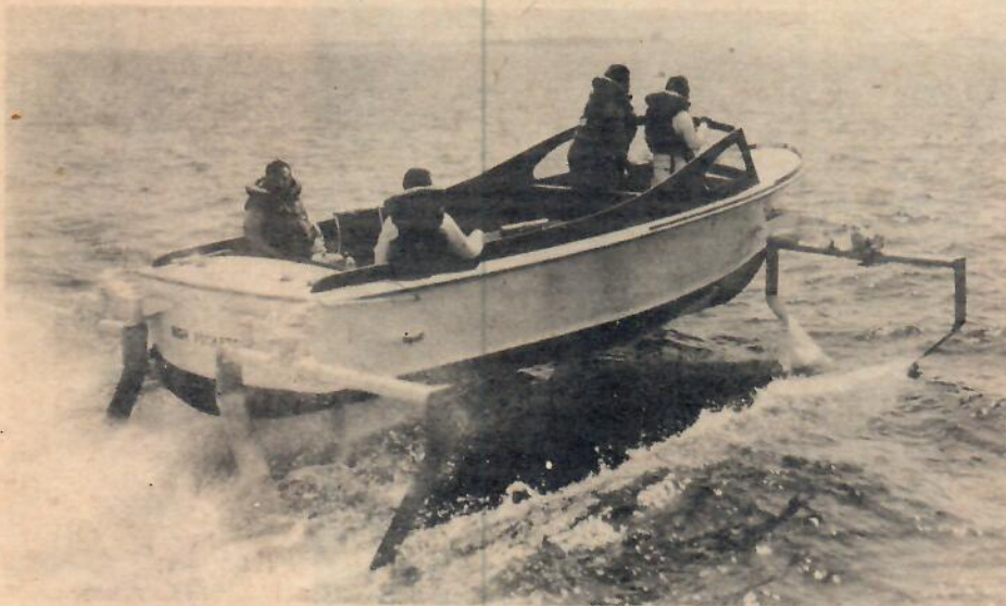
Förenta Staternas Flotta experimenterar för närvarande med bärplansbåtar. Detta är den i texten omtalade High-Pockets. Motorn är en Chrysler på 125 hästar och den ger båten en toppfart på ca 38 knop. Utan bärplan gjorde båten med samma motor endast 20 knop. En kraftig ökning.
