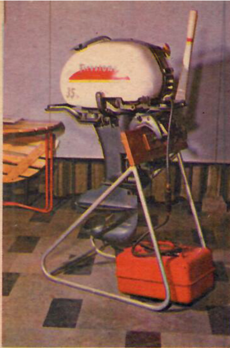
FIRESTONE — här i 35-hästarmodellen — är identisk med motsvarande Scott-Atwater-modell, men har annan motorhuv. Extra finess: knopmätare.
