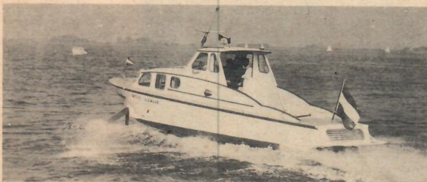
Här är en fiskebåt, byggd enligt bärplanssystemet. Den är byggd av Supramar i Schweiz och har visat sig utmärkt för insjöfiske. Toppfarten är dryga 30 knop. Skrovet är helt konventionellt.
