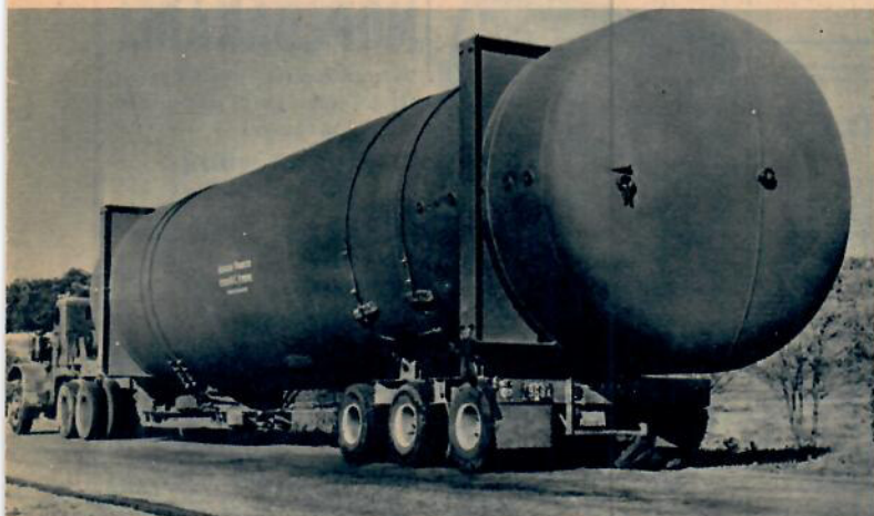
I Amerika frakts denna jättestora högtryckstank för gas med en speciell traileranordning. Tanken vilar på dragfordonet och på en sexhjulig vagn. Mellan dessa finns ingen förbindelse förutom bromslingor och kablar.
