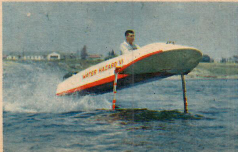
Farten ökar (ovan) och båten börjar komma upp på bärplanen. Ännu har båten ej nått toppfart. På den under bilden, slutligen, rusar bärplansbåten fram i toppfart.
