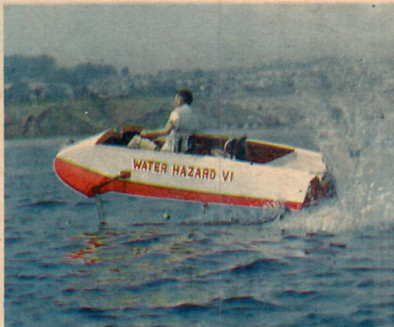
Farten ökar (ovan) och båten börjar komma upp på bärplanen. Ännu har båten ej nått toppfart. På den under bilden, slutligen, rusar bärplansbåten fram i toppfart.
