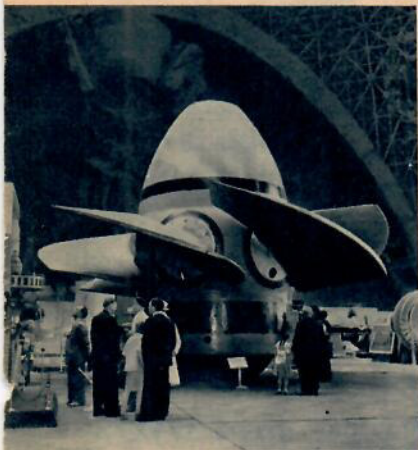
På industriutställningen i Moskva visades bland andra tekniska produkter detta löphjul till en Kaplan-turbin. Det har sex ställbara skovlar. Vikten är imponerande: 426 ton
