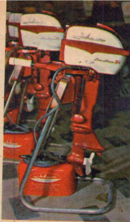
JOHNSON SEA HORSE 5 1/2 är en av de populäraste amerikanska »sportfiskemotorerna». Frigång och back samt separat bränsletank.
