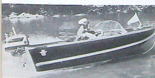
Aero-Craft bygger sina båtar i aluminium och ger livstidsgaranti mot läcker. Campingbåten Sea Mist är 4,3 m lång och har byggts för motorer på upp till 45 hk. Panoramarutan är tillverkad av plast.
