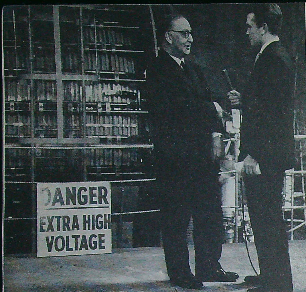
Denna totalvy av ZETA visar det stora ringformiga urladdningsröret som har en diameter av ca sex meter. Omkring röret syns den väldiga transformatorlindningen, som alstrar kraftiga magnetfält för att åstadkomma "pinch-effekten", dvs. att gasen snörs ihop till ringens centrumlinje. Urladdningsröret utgör transformatorns sekundär.
