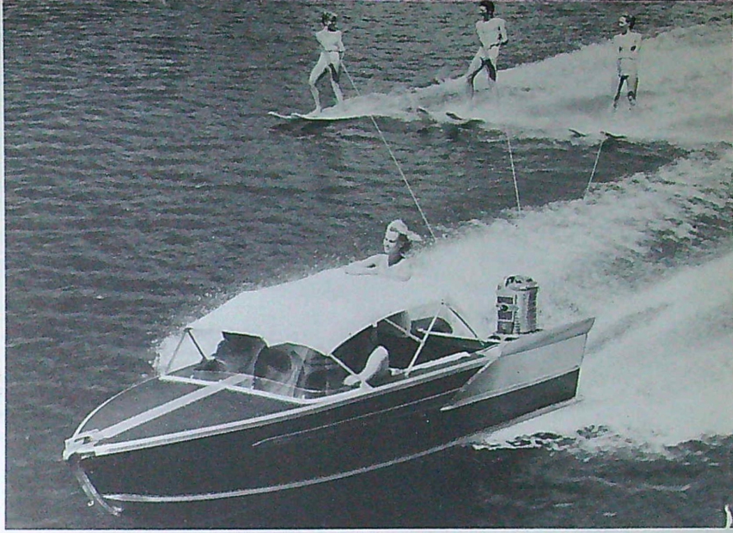
För vattenski sport lämpar sig båtar med rejäla motorresurser. Feather Crafts Clipper är en aluminiumbåt med en 60 hk Mercury-snurra. Här bogserar den tre vattenski sportare med 25 knops fart.
