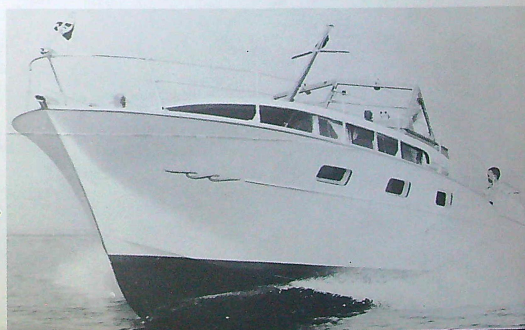
Cavalier Sports Utility tar sex passagerare och gör 26 knop med två utombordsmotorer på sammanlagt 70 hk. Lägga märke till tvärskottet bakom förarplatsen med det V-formade urtaget för passage.
