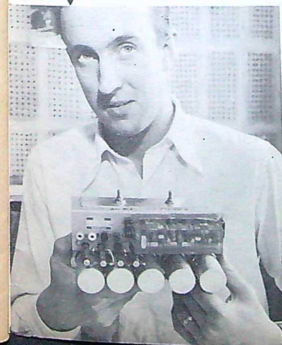
AB Hägglund & Söner i Örnsköldsvik har konstruerat en elektronisk apparat, populärt benämnd slirvakt, som automatiskt ingriper när ett hjulpar börjar slira. Konstruktionen har redan tagits i praktiskt bruk på de spårvagnar, som nu levererats till Göteborg. Denna apparat bygger på transistorer, som är ingjutna i fukt säkert hölje.
