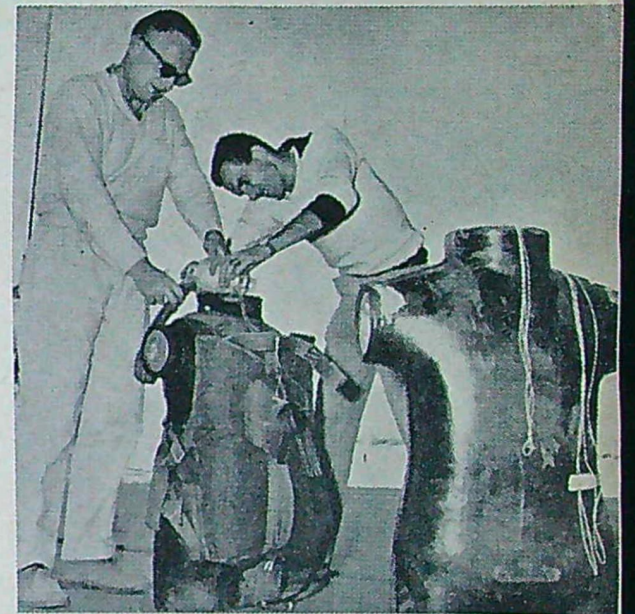
Vid proven har man använt sig av provdockor med en vikt av ca 100 kg. Dessa gummidockor har använts vid prov med den fallskärmsstyp som konstruerats speciellt med tanke på rymdplanet X-15. Dockorna har instrument som mäter G-krafter etc.
