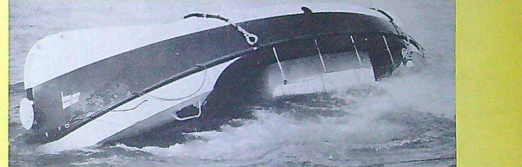
Den engelska sjöråddningen har fått en ny typ av livbåt, som är 11 meter lång och deplacerar nio ton. Båten kan inte kontra. Om den vråks omkull av en kraftig sjå, råtar den upp sig inom sju sekunder.
