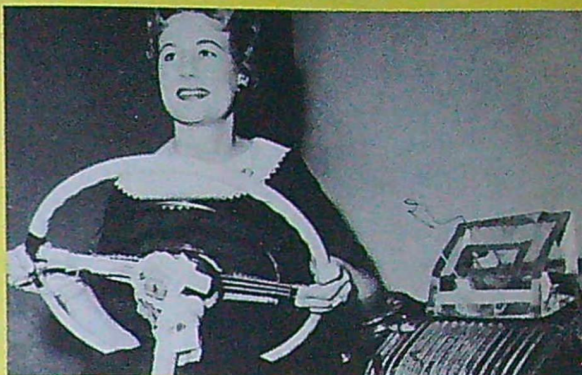
Flickan på bilden heter Jackie Sweet och hon demonsturerar en amerikansk nyhet för ökad trafik-såkerhet. Det gåller ett slags dödmånggrepp av samma typ som t. ex. järnvågarna anvånder. Somnår bilisten, slås tåndningen av och bilen stannår.
