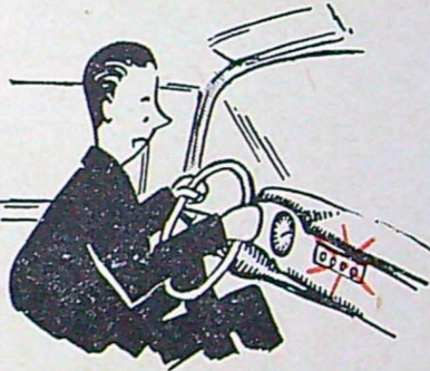
SKVALLER-LAMPA som omedelbart talar om, när någon av motorns cylindrar inte ger full effekt, vore en fin hjälp, tycker Anders Byrdeman, Löd-ösevägen 8, Johanneshov. Felsökningen skulle i flera fall kunna inskränkas till tändstiftsbyte.
