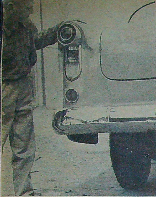
Bakljusarrangemanget på nya Kapitän har fått svälla ut en hel del, jämfört med tidigare modell. Överst bakljus, därunder bromsljus och blinkers.
