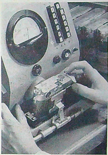
Kontroller och återkontroller sätter sin prägel på tillverkningen. Ovan finjusteras tiderna för en Leicas ridåslutare med hjälp av ett känsligt mätinstrument. Bilden nedan visar den del av monteringshallen där man gör den avslutande trimningen av den nya Leica-modellen M3:s bildrumsökare. Det är ett omfattande arbete att montera en kamera. En enda Leica-kamera kräver hela 8 049 arbetsmoment. . . .
