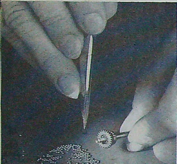
Det krävs känsliga fingrar för att montera kulagret i Leicans ridåslutare (ovan). Leitz tillverkar även mikroskop och nedan kontrolleras mikroskopspeglar med ett optiskt specialinstrument.
