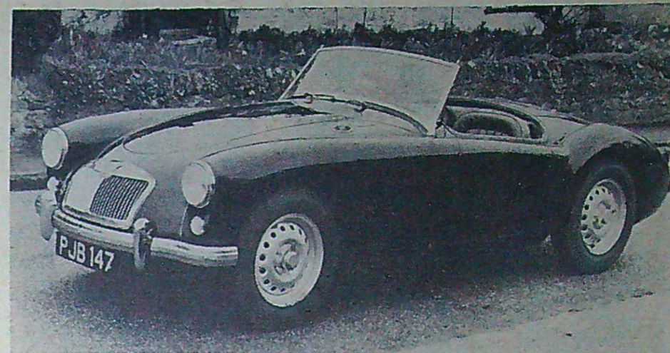
Utseendemässigt skiljer sig den starkare versionen från standardmodellen endast i några små detaljer. Observera de nya hjulläpparna, som är specialutformade för att ge plats för skivbromsarna.
