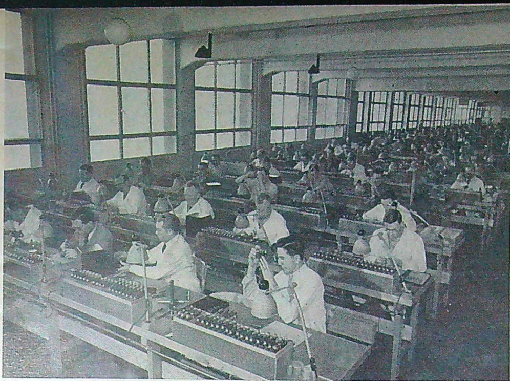
Leitz-fabriken dominerar hela Wetzlar med sina 7 000 anställda. Överst den stora monteringshallen, där skickliga yrkesarbetare monterar ihop de precisionstillverkade delarna till Leicakameror. Bilden t. h. objektivlement klara för montering.
