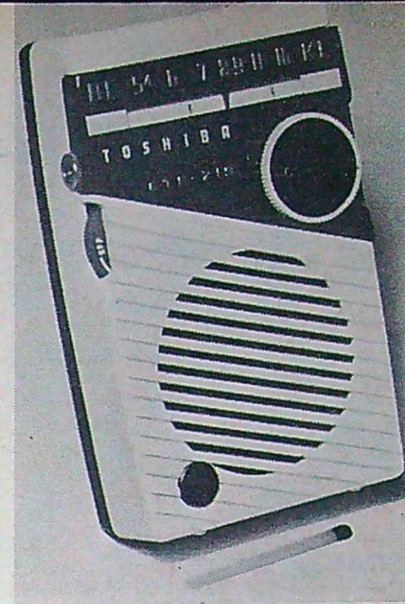
En miniatyrradio med sex transistorer visades av firmen Elof Hansson. Toshiba Transistor Six tillverkas av Japans största eltekniska koncern och är en högkänslig superheterodyn-mottagare med mätten 145x38x80 mm. Apparaten väger 500 gram och drivs med stavbatterier. Priset är 220 kr.
