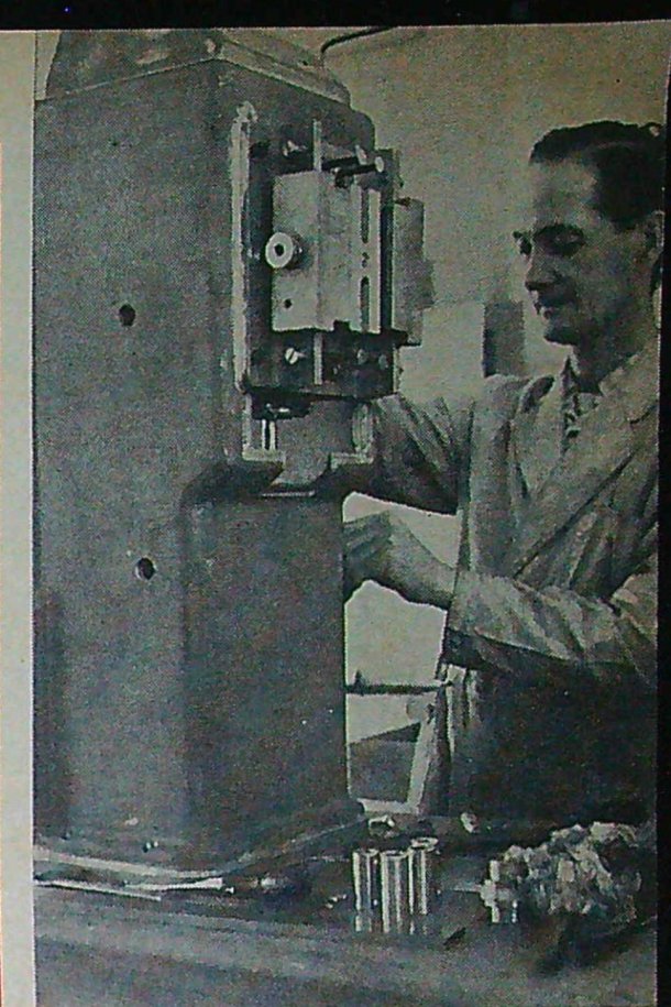
Filaren Bror Andersson arbetar här med monteringen av pumpanordningen, som pumpar upp blodet från oxygenatorn. Genom två mothållskuddar regleras pumpförmågan så att den exakt motsvarar den blodmängd, som kommer från patienten.
