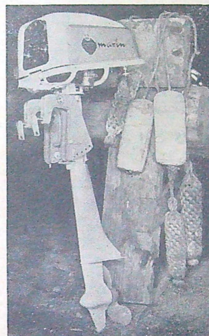
NV-Marin är Sveriges mest sålda utombordsmotor. 1958 års modell har en ny strömlinjeformad rigg. Dragkraften har ökats genom förbättrat avgassystem och motorn ger nu något över uppgivna 2,5 hk.
