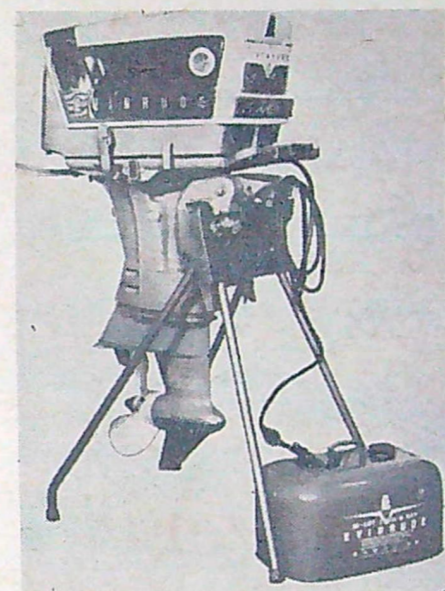
En bjässe för akterspegeln! Evinrude Four-Fifty är en V-4:a som utvecklats 50 hk vid 4000 v/min. Jätten väger 89 kg och suger ur en 22,7 l trycktank på en timme. Kylningen är termostatreglerad. Motorn, som är god för farter på över 30 knop, är upphängd i vibrationsdämpande gummelement.
