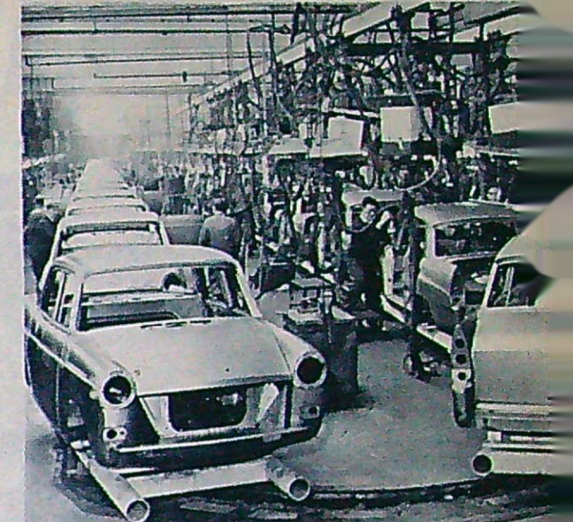
Pressed Steel's press- och monteringshallar är rejält tilltagna. Automationen är långt driven och yrkesskickligheten stor. Här är en ny serie Morris Oxford på väg till lackeringsavdelningen.
