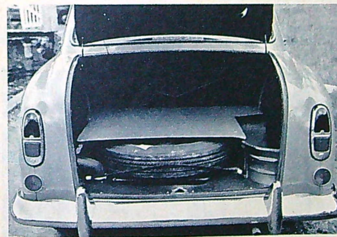
Bagageutrymmet är normalt för en vagn i familjebilklassen. Reservhjulet stjäls emellertid en del plats (översta bilden). På den undre bilden en skojig detalj på Peugeot 403: bränslepåfyllning sker genom ett av vänstra baklyktans underdel skytt tankhål.
