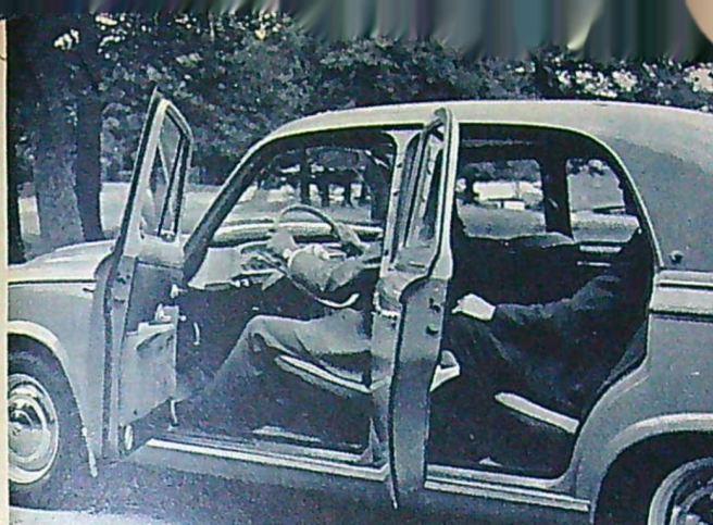
Dörrarna på Peugeot 403 är upphängda i framkanten. De är stora och tillåter bekväm in- och utstigning. Inne i vagnen finns det gott om plats för fyra personer. Baksätet kan t. o. m. ta tre åkande.
