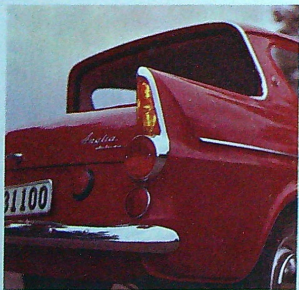
Nya Anglia har ingenting gemensamt med sin föregångare. Det är nytt hela vägen, såväl i karossform som under huven. Vagnens mest karaktäristiska drag är den bakre taklinjen med den snedställda bakrutan. Vinst: bättre takhöjd. Förlust: en »hatthylla».
