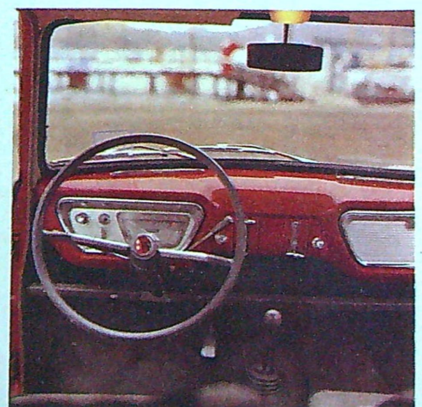
Omfattande marknadsundersökningar föregick den här vagnens framställande. Bl. a. intervjuades bilister om vilken instrumentering man absolut fordrade. Och här ses resultatet. Att märka är att låset till motorhuven har placerats på instrumentpanelen.
