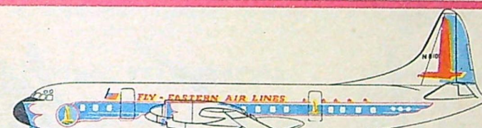
LOCKHEED 188 ELECTRA. 4-motorigt turboprop-plan för medellånga och långa distanser. 66—91 passagerare. Fart 575 km/t. Flygsträcka 4.500 km. Flög f. f. g. i december 1957. Olika flygbolag har beställt 160 plan.
