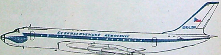
TUPOLEV TU-104. 2-motorigt jet-plan för medellånga distanser. 50—80 passagerare. Fart 825 km/t. Flygsträcka 3.000 km. Ca 100 Tu 104 och Tu 104A (med starkare motorer) flyger på ryska inrikeslinjer samt Europa.
