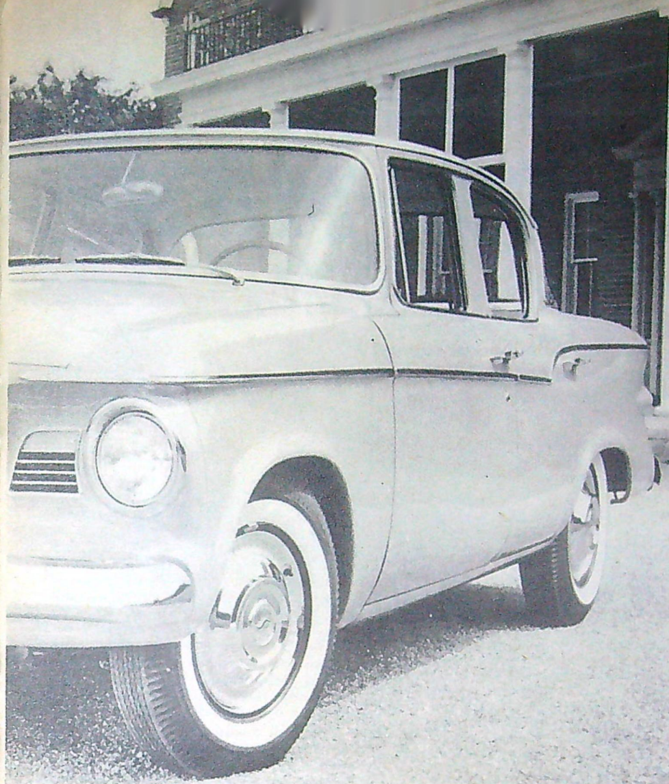
Taket har inte dragits ner för mycket utan man kan sitta bekvämt med hatten på även om man är långväxt. Vid konstruktionen av bilen har man gjort en del kostnadsbesparande åtgärder. Bakre och främre stötfångare är exempelvis lika och hela frampartiet är gjort i ett stycke. Ett steg i rätt riktning.
