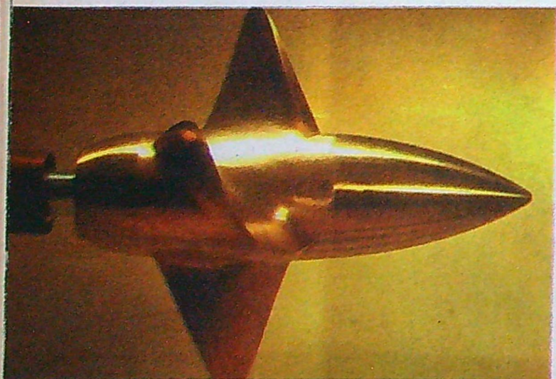
Propellerproven i kavitationstanken är ett färggrant skådespel. På denna bild — tagen genom tankens glasruta — är propellern stillastående.
