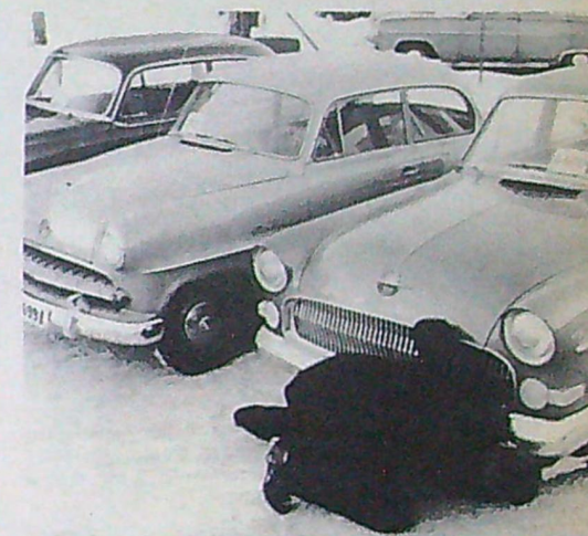
Taket har inte dragits ner för mycket utan man kan sitta bekvämt med hatten på även om man är långväxt. Vid konstruktionen av bilen har man gjort en del kostnadsbesparande åtgärder. Bakre och främre stötfångare är exempelvis lika och hela frampartiet är gjort i ett stycke. Ett steg i rätt riktning.
