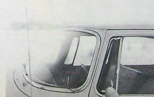
Panoramarutan är som synes inte så skarpt böjd vid kanterna som på vissa andra amerikanare. Sikten är ypperlig men de elektriska vindrutetorkarna sveper tyvärr över en alltför liten yta av rutan.
