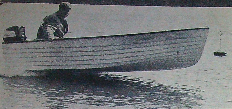
Åtskilliga timmar till sjöss ingår naturligtvis i utprovnigen av en ny båtmotor. Här har den nya svenska 8 hk-snurrans konstruktör, ingenjör Gösta Stillerud, ovan och t.h., fångats under provtur med nyheten monterad på en hyperlätt, italiensk plastbåt, som även kommer att säljas i Sverige. 16 knop gör 65-kilosbåten med den motorn, som dock mest kommer att dra tyngre båtar än så.
