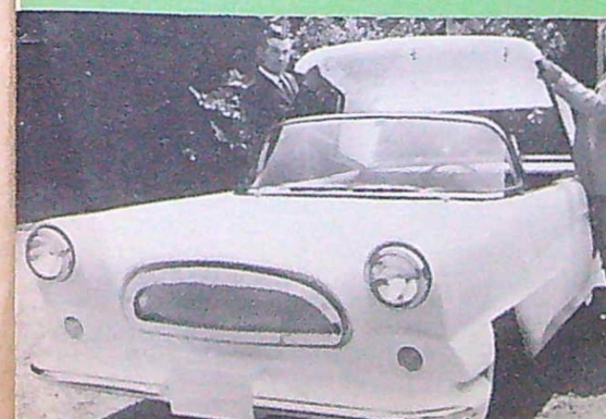
För USA-marknaden är den här nya plastbilen tänkt. Shamrock heter modellen, som har Austin A 55:s motor och även i övrigt BMC-detaller under plastskallet. Tillverkningen förlägger man till Irland.
