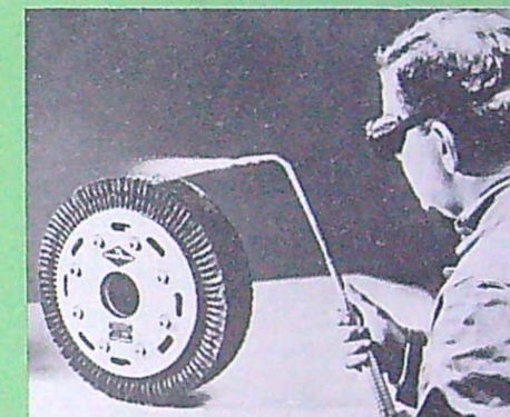
Sveltslāgan biter inte pā detta däck, som konstruerats av Goodyear. Däckets skall användas på landningshjul för rymdraketer och skall motstå påkänningarna dā raketen passerar värmevallen.
