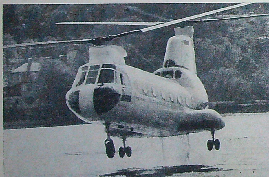
Vertol 107 landar lika bra på vatten som land. Den är konstruerad som amfibie och tål 1,5 m höga vågor. Amfibieegenskaperna har uppnåtts utan att flygkroppen behövt utformas som båtskrov. Då det inte finns risk för att någon rotor skall slå i vattnet kan därför låga sättningshastigheter användas.
