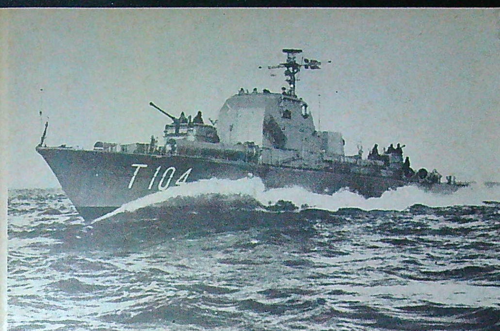
Torpedbåtarna av Polaris-klassen är världens största fartyg i sitt slag. De är bestyckade med två 40 mm Bofors-kanoner och sex torpedtuber. Farten är omkring 40 knop. På bilden t.h. styr en motor-torpedbåt ut i solnedgångsglittret för att några timmar senare öva mörkerstrid långt ut till havs.
