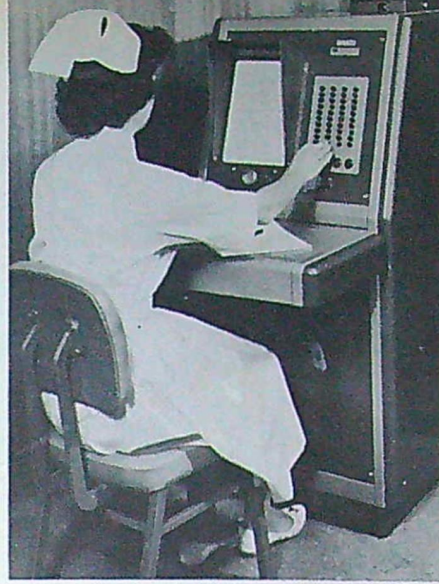
En elektronisk lärare är senaste nytt från USA. I fönstret t. v. visas lektionsfrågor, och eleven svarar genom att välja rätt svarsknapp. Efter rätt svar kommer en ny lektion i fönstret.
