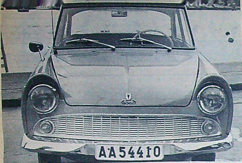
Fronten på DKW Junior är enkel utan pråliga utsmyckningar. Sikten framåt är god, även vid regnväder då torkarna torkar ett sammanhängande fält.
