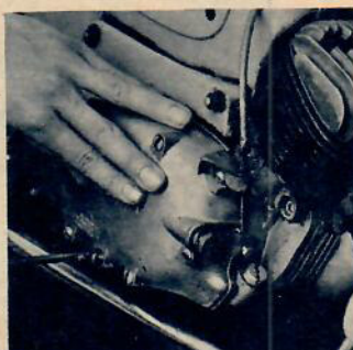
Luftfilter av denna typ blir effektivt rent med fotogenbad och pensel.
