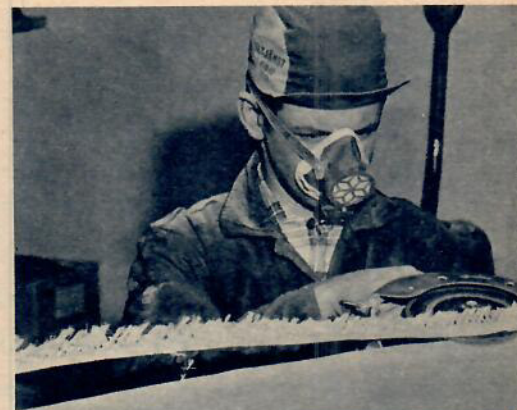
Det färdiga skrovet lyfts ur sin form och bör redan då vara blankt och slätt. Råkanten upp till skärs av med en sågklinga. Den grova väven är den s. k. rowingväven som ligger innerst.
