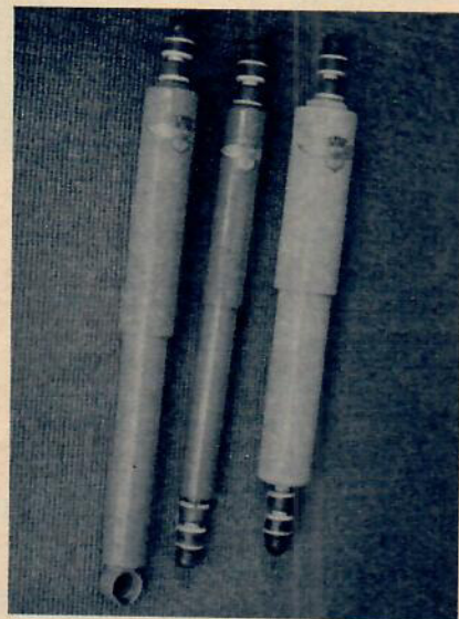
Teleskopstöttdämpare av olika typer men av samma fabrikat, Koni. Finns för alla bilar.
