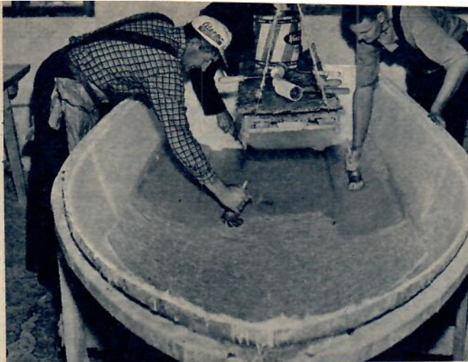
Ytväven är lagd och den första armeringen, en glasfiberatta, lagts i skrovet. Plasten arbetas in med penslar.
