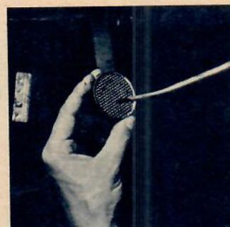
Det är viktigt att filtret efter rengöringen oljas in. Oljan stoppar smuts.
