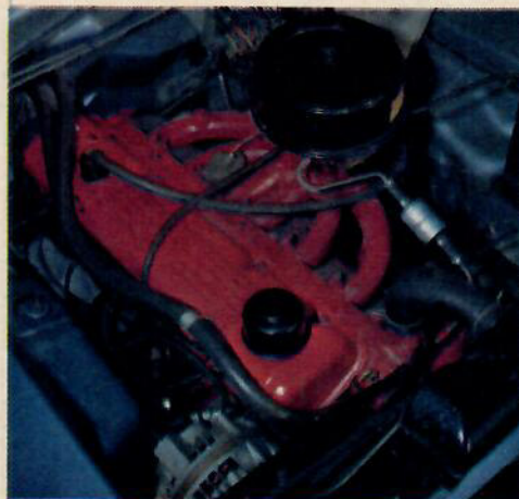
Motorn lutar 30 grader till höger. Det är gott om plats under huven och förvånande fritt från allt ris.
