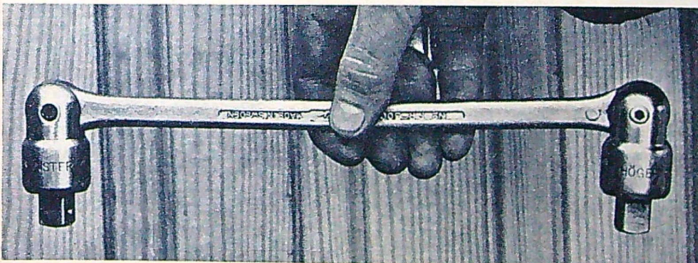
Ovan ett behändigt spärrskaft, specialgjort för trånga ställen. Man bara »byter sida» beroende på om man skall lossa eller dra en bult! Till höger ett verktyg från Momena med vilket man kan lossa och dra pinnbultar utan att skada dem.
