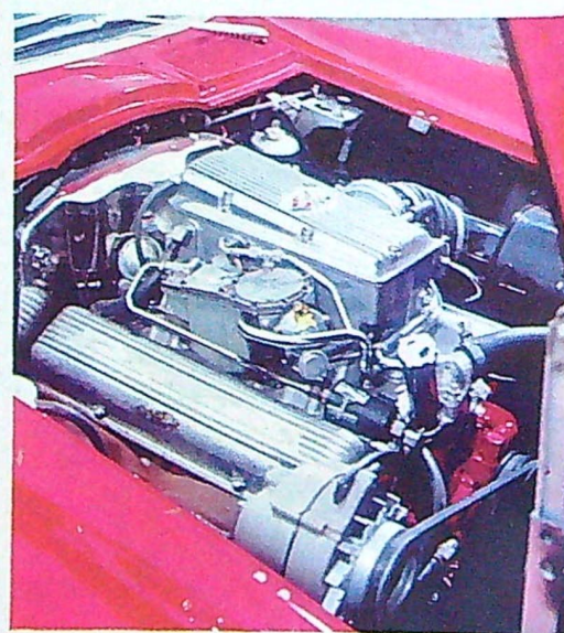
Corvette Sting Ray är en verklig sportvagn, trots att den byggs i USA. Den vassaste versionen har en motor med direktinsprutning, fyrväxlad manuellt manövrerad låda och synnerligen rikligt utrustad instrumentpanel. Övan till vänster det parti av nya Corvette som andra bilister troligen oftast får se när det blir grönt ljus. Övan en motorbild med direktinsprutningsaggregat mellan ventilåpningarna samt till vänster instrumentpanelen.
