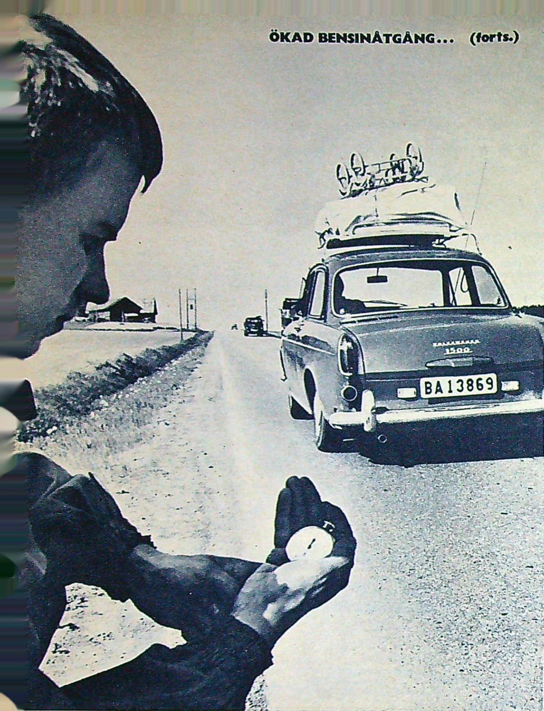
Mätsträckan kördes i båda riktningarna med en konstant fart av 100 km/t. Kronometer användes för att kolla accelerationstider och genomsnittsfart.
