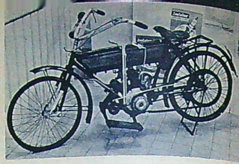
NSU:s V-2:a från 1904. Men den hade faktiskt automatiska insugningsventiler och steglös låda.
