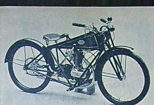
Det här är en svensk maskin, EBE, som började byggas i Åmål 1919. 175 cc motor, toppventil.
