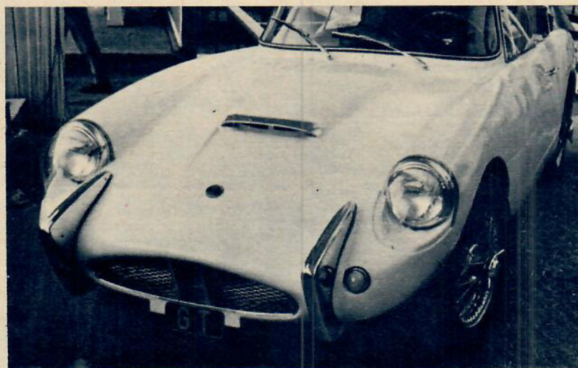
Israel bygger också sportvagnar! Sabra GT heter denna eleganta kupémodell, som har fått en plastkaross och försetts med en Consulmotor, som borrats upp till 1.700 cc.
